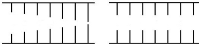
شکل ۱: ساختار موج‌رونده امپدانس ثابت (سمت راست) - ساختار موج‌رونده گرادیان ثابت (سمت چپ)
