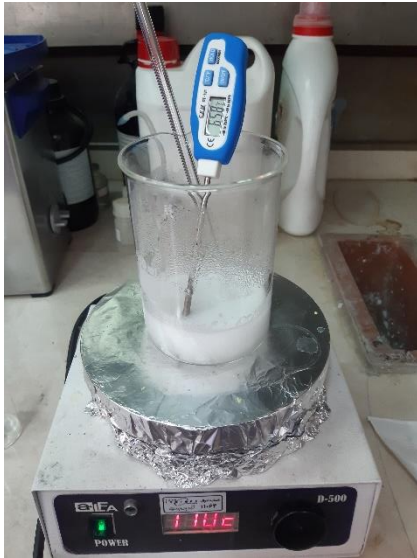
شکل ۱: انحلال پلیمر PVA در ۲۰۰ سی سی آب مقطر به کمک همزن مغناطیسی و پایش دمای محلول در طول فرایند انحلال.
