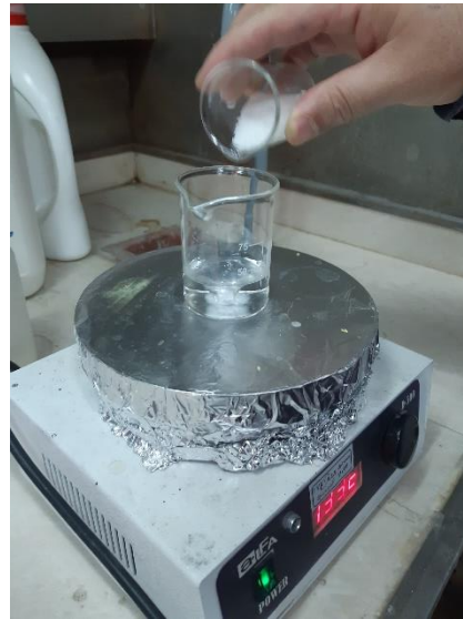
شکل ۱: انحلال پلیمر PVA در ۲۰۰ سی سی آب مقطر به کمک همزن مغناطیسی و پایش دمای محلول در طول فرایند انحلال.
