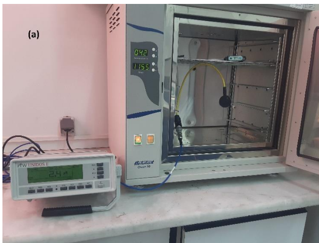
شکل ۸: نمایی از ست‌آپ و رفتار دزیمر ساخته شده در دماهای مختلف مابین ۰ تا ۴۵ درجه سانتی گراد
