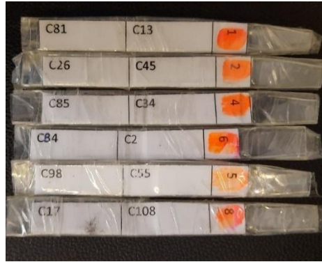
شکل ۱. نمونه آشکارسازهای CR-39 برای انتخاب پارامترهای خورش شیمیایی به منظور آشکارسازی نوترون سریع و حرارتی.
