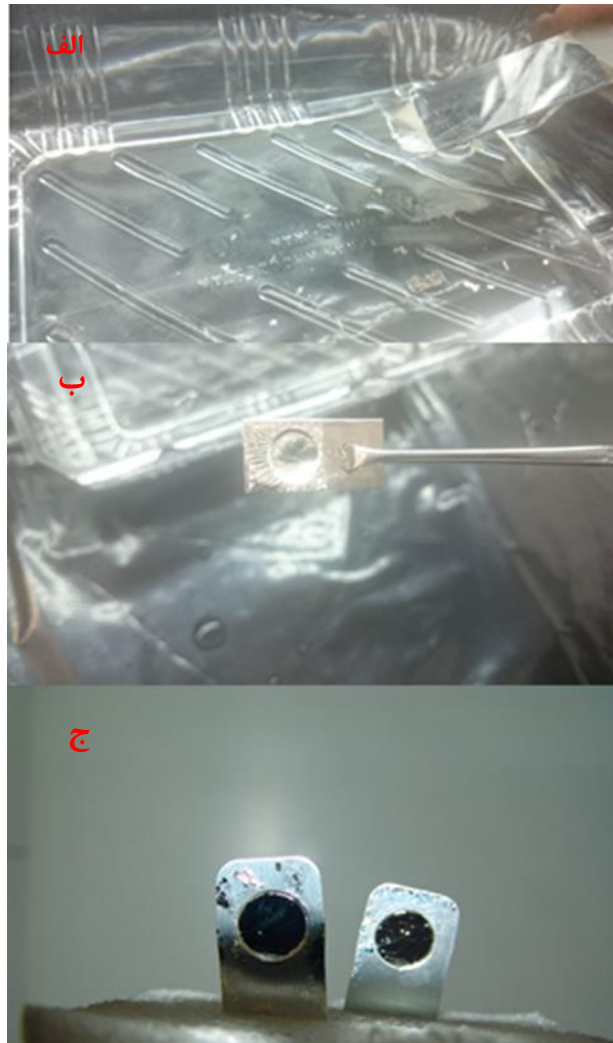
شکل ۱. الف) غرق کردن زیر لایه نقره در آب گرم، جدا شدن لایه نقره از شیشه، ب) مرحله فیشینگ هدف، ج) زیر لایه‌های ساخته شده
