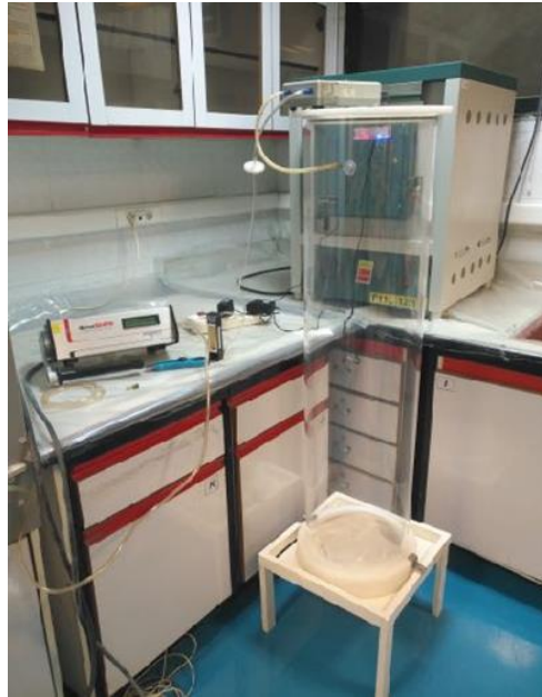
شکل ۲. دستگاه طراحی و ساخته شده برای اندازه‌گیری شار رادن و چیدمان آزمایش.
