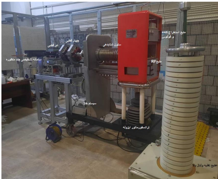
شکل ۱. شتاب‌دهنده الکترواستاتیک ساخته شده در پژوهشکده فیزیک و شتابگرها (سمت چپ)، چشمه یونی رادیوفرکانسی القایی (سمت راست).
