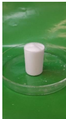
شکل ۱. الیاف پیوندخورده با ۴۰٪ حجمی GMA
