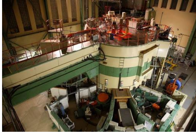
شکل ۲. نمایی از حفاظ‌سازی اطراف سیستم‌های پراش‌سنجی نوترون راکتور LVR-15 جمهوری چک [۲].
