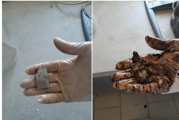
شکل ۲. آهن جذب شده توسط آهنربا در حین شستشوی کیک فیلتر گرم روی با آب
