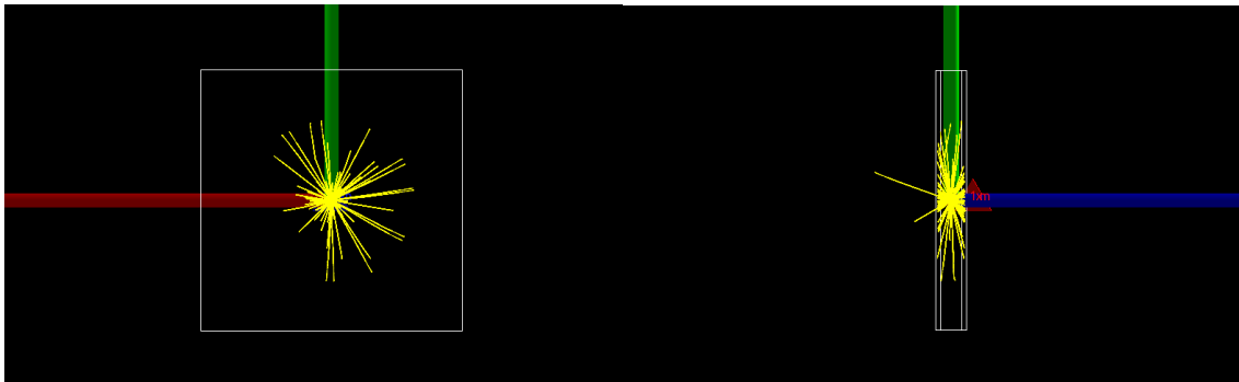
شکل ۱: نمایی از شبیه‌سازی یک مقطع بافت ریه به ابعاد 1 \times 1 \times 0.01 \text{cm}^3 با چشمه آلفای نقطه‌ای
