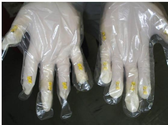
شکل ۱. نحوه قرار گیری چیپس های TLD-100 بر روی انگشتان دستان پرتوکار
