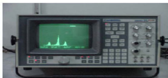
شکل ۱: طیف بدست آمده از نمونه نهایی، پیکها به ترتیب از چپ به راست مربوط اند به ^{210}\text{Po} ، ^{208}\text{Po} ، ^{209}\text{Po}
