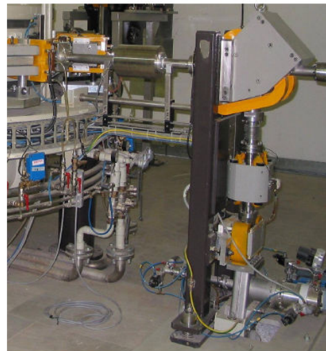
شکل (۵) خط انتقال با مگنت ۹۰ درجه شکل (۴) نحوه عبور باریکه الکترون از مگنت ۹۰ درجه
