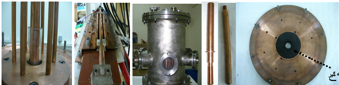
شکل (۴): تصاویری از دستگاه پلاسمای کانونی امیرکبیر، (الف) صفحه کاتدی مسی، (ب) میله کاتدی (شش عدد)، (ج) الکتروود آند، (د) محفظه تخلیه و پنجره های آن، (ه) آند، کاتدها و عایق پیرکس، (و) اسپارک گپ ریلی
