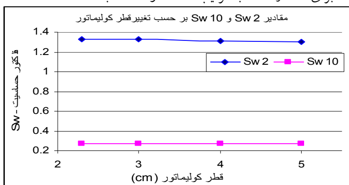
شکل (۶): فاکتور حساسیت بر حسب تغییر قطر کولیماتور در کک با درصد وزنی آب ۲٪ و ۱۰٪.
