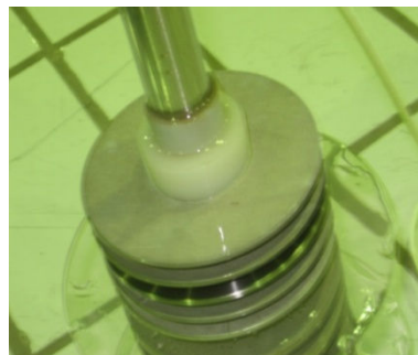
شکل (۳): وضعیت رک خوردگی بعد از ۳ ماه ماندن در داخل استخر راکتور تهران
