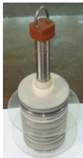
شکل (۳): وضعیت رک خوردگی بعد از ۳ ماه ماندن در داخل استخر راکتور تهران
