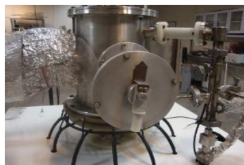
شکل ۲- دوربین روزنه سوزنی دستگاه پلاسمای کانونی شریف.
