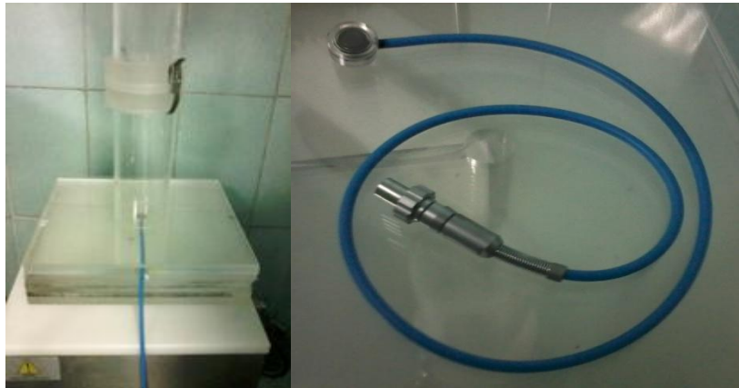
شکل ۳. نمایی از اندازه گیری عملی و Advance markus chamber برای سنجش دز الکترون
