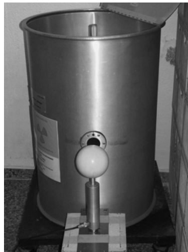
شکل ۱: چشمه Am-Be و سامانه طیف‌سنجی نوترون کره‌های بانر.
