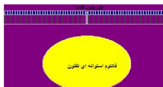
شکل ۴. نمایی از مقطع فانتم تفلون با ضخامت ۱۴ سانتی‌متر به همراه دوربین گاما شبیه سازی شده با کد MCNP4C
