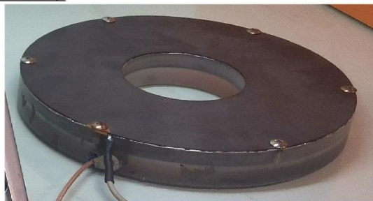
شکل (۱): نمایی از دژیمتر بیم الکترونی حلقوی شکل و اطلاعات فنی آن.
