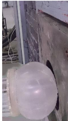
شکل (۳): نمایی از فانتوم تحت تابش باریکه راکتور تهران
