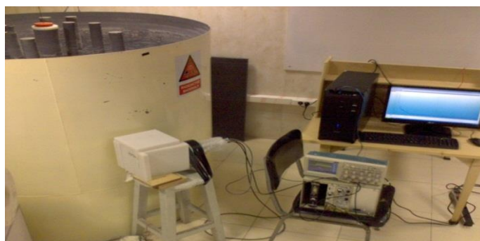
شکل ۴- تانک چشمه آزمایشگاه و تجهیزات چیدمان آزمایش PGNAA استفاده شده در آزمایشگاه شهید دکتر شهریار
