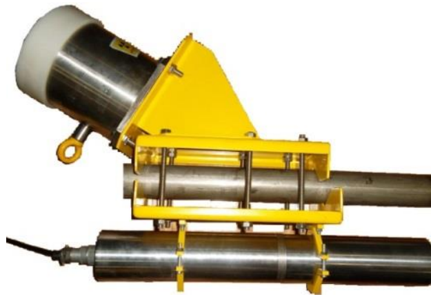
شکل ۱. دستگاه چگالی‌سنج پرتوی گاما
