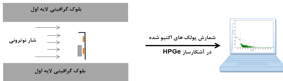
شکل (۱): نمایی از فرایند آزمون نوترونی در ستون حرارتی راکتور تهران
