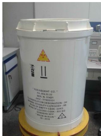
شکل ۱: نمونه ای از بشکه های ۲۰۰ لیتری کلاس 3H برای نگهداری از پسمان های نیروگاه اتمی بوشهر
