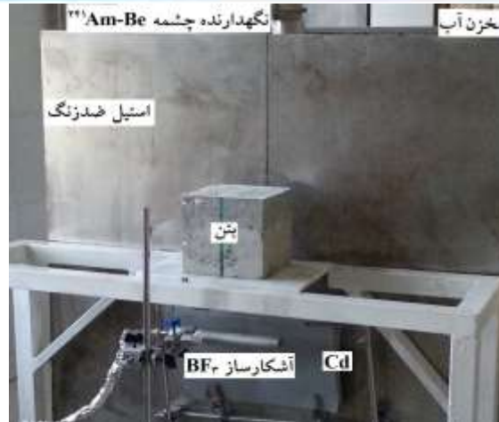
شکل (۱). تصویر آزمایش پرتودهی به بتن و آشکارسازی نوترون‌های بازتابی توسط آشکارساز BF_3 .
