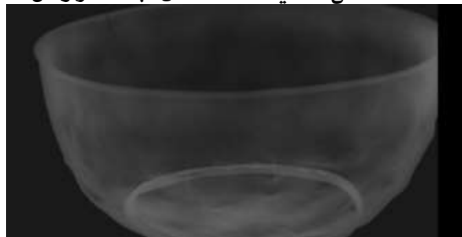
شکل ۲ تصویر رادیوگرافی کاسه عتیقه
