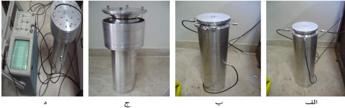
شکل ۵: تصاویری از کاواک کواکسیال آلومینیومی ساخته شده جهت تست‌های آزمایشگاهی طرح تزویج توان مستقیم
