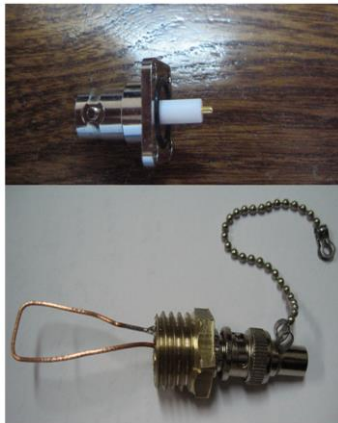
شکل ۲: نمونه پراب و کوپلر اندازه‌گیری
