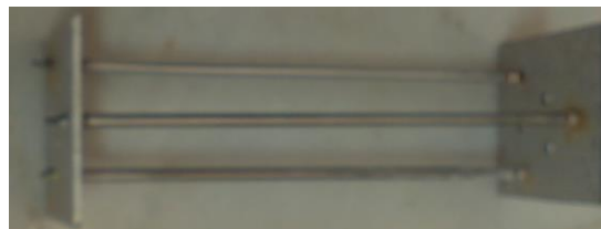
شکل ۱: المنت‌های حرارتی با غلاف استیل
