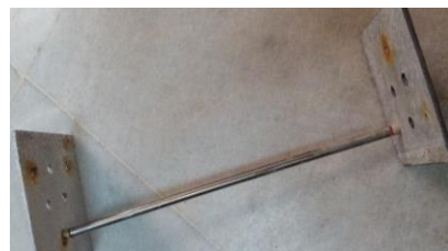
شکل ۲: خوردگی در کاتد و آند آلومینیومی
