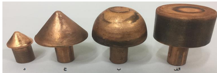
شکل ۱- هندسه‌های مختلف توننده‌ی آند الف (تخت، ب) گنبدی، ج) مخروطی بزرگ و د) مخروطی کوچک
