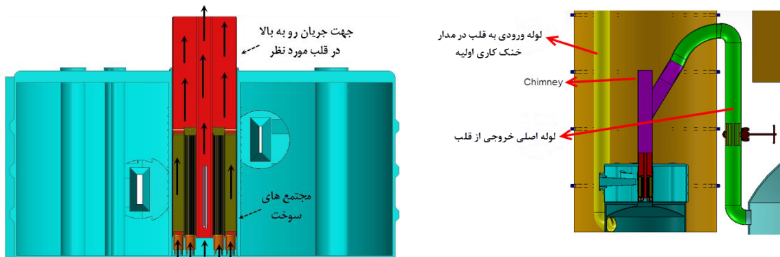
شکل ۳- جهت جریان رو به بالا در عبور از کانال های مجتمع های سوختی راکتور ۲۰ مگاواتی مورد نظر
