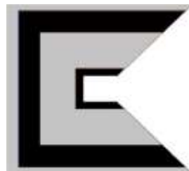
شکل ۱: تولید کننده نوترون و حفاظ مربوط به آن. لایه خاکستری پلی اتیلن و لایه سیاه استیل می‌باشد
