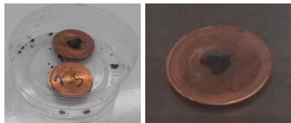
شکل ۳: نمونه قرص پرتودیده و باز شده که محتویات آن درون ظرف مخصوص تخلیه شده است.
