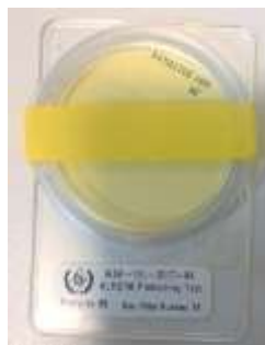
شکل ۴- نمایی از چشمه استاندارد برای کالیبراسیون آشکارسازهای هسته‌ای
