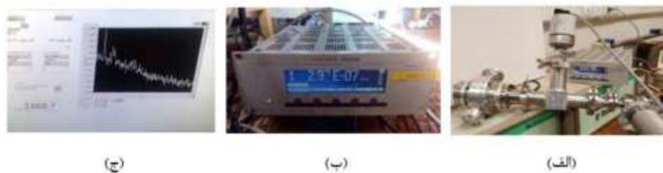
شکل (۵) الف) چیدمان اندازه‌گیری خلا در آزمایشگاه ب) مقدار خلا خوانده شده از گیج (پ) مقدار خلا خوانده شده توسط
