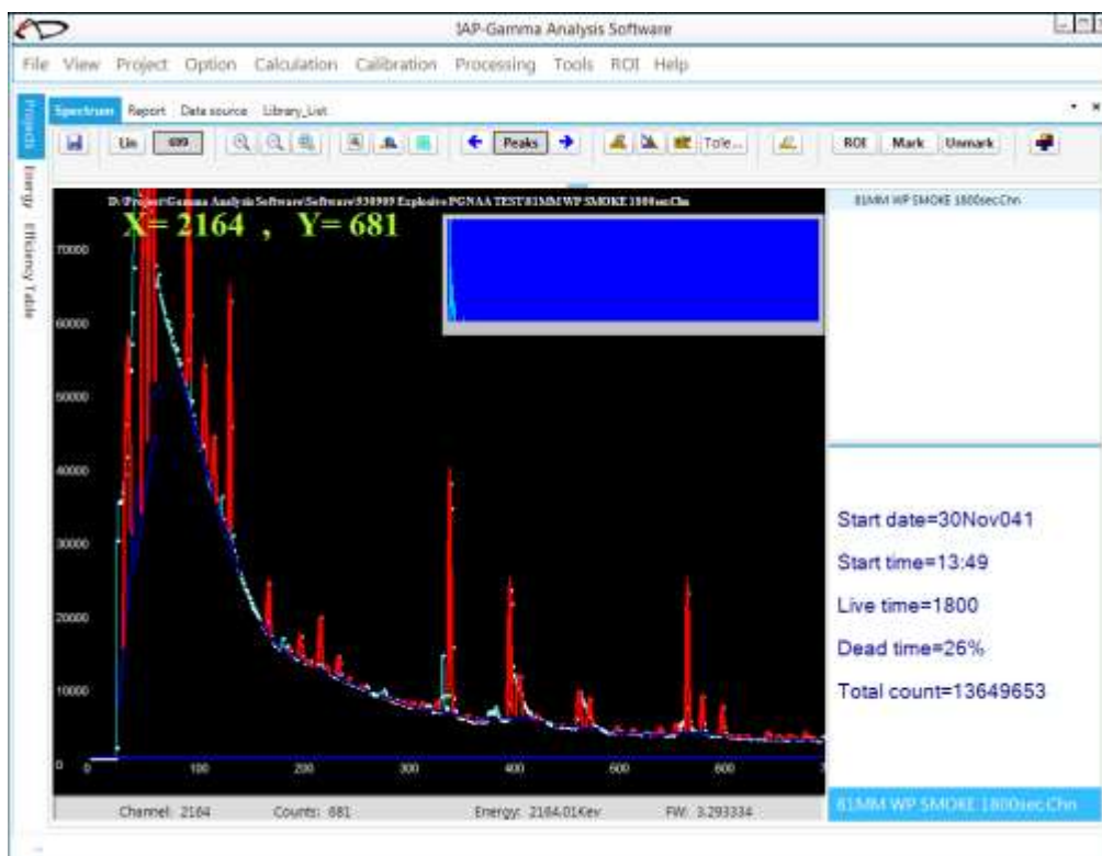
شکل ۳. کم کردن طیف نمونه مورد نظر از طیف چیدمان و قله‌یابی طیف توسط نرم افزار
