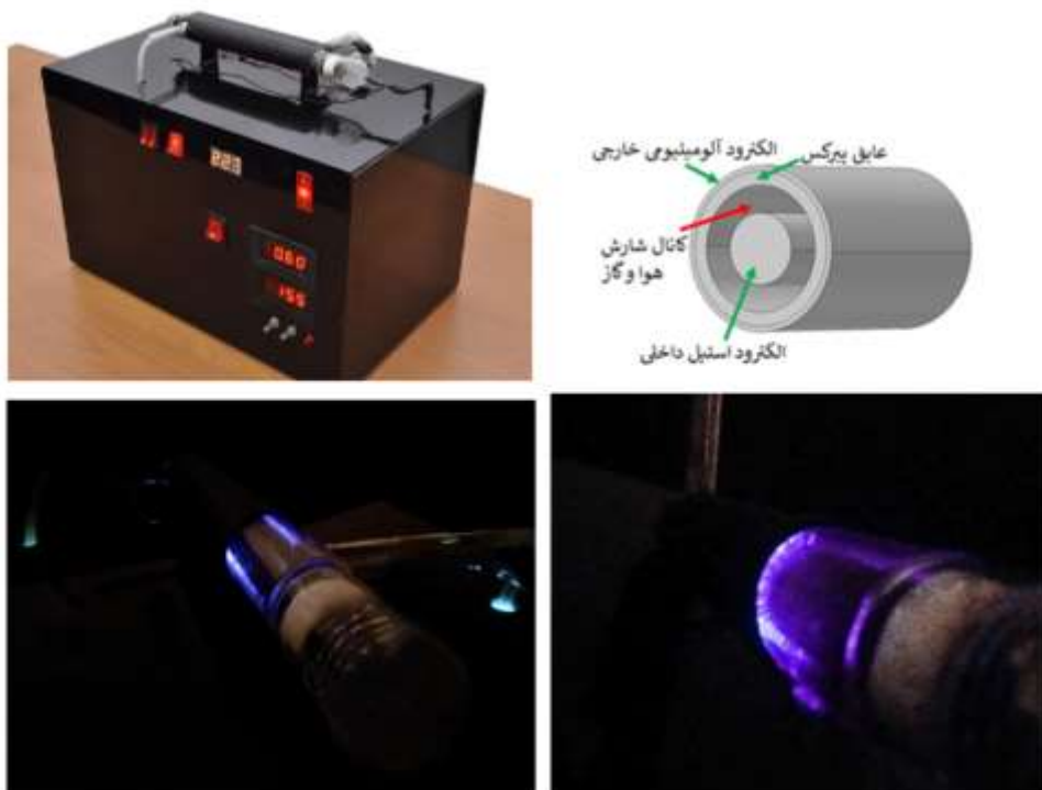
شکل (۱) (راست بالا) شماتیک سیستم تخلیه سددی الکتریک (DBD) (چپ بالا) تصویر نمای کلی دستگاه (پایین چپ و راست) تصاویری از تشکیل پلازما در کانال
