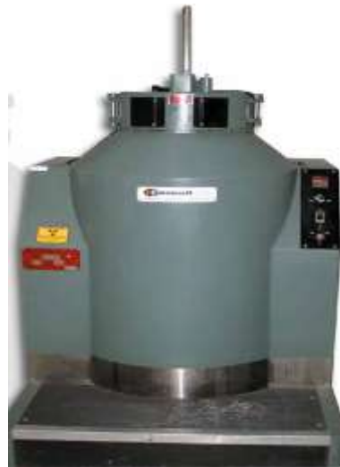
شکل (۳) نمایی از سیستم پرتودهی گاماسل GC220.
