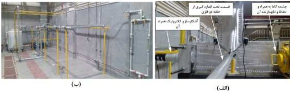
شکل (۱): چیدمان آزمایش: الف) سیستم آشکارسازی و اندازه‌گیری، ب) نمایی از حلقه دوفازی مورد نظر در محیط آزمایشگاه
