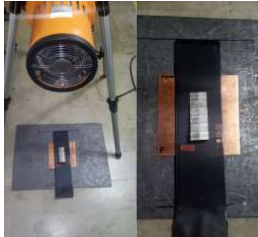
شکل ۵. گوه های فولادی و آلومینیوم در کنار هم برای تصویربرداری ایکس دو-انرژی.
