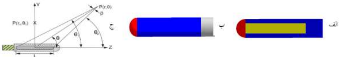
شکل ۱: (الف): کپسول Nucletron mHDR-v1 شبیه‌سازی شده توسط کد GATE، (ب): کپسول شبیه‌سازی شده توسط کد GATE به همراه کابل آن، (ج): هندسه در نظر گرفته شده برای محاسبات دُزیمتری.
