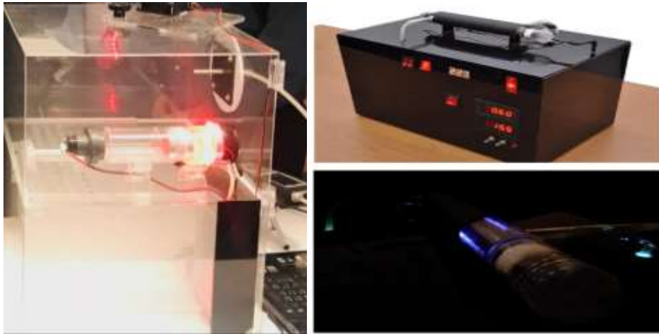
شکل ۲- (راست) نمونه آزمایشگاهی اولیه تخلیه سدیدی الکتریک (DBD) و تشکیل پلازما در کانال دایروی - چپ) تصویر نمای کلی دستگاه ساخته شده (قسمت بالا، دستگاه روشن و هوای تازه، قسمت پایین دستگاه خاموش و پر از دود است)
