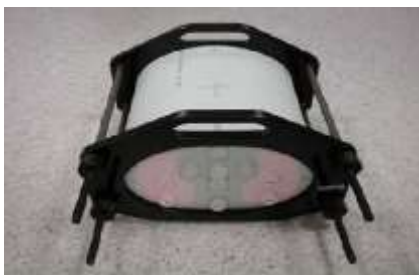
شکل ۱- فانتوم ناهمگن IMRT قفسه سینه مدل CIRS 002 LFC
