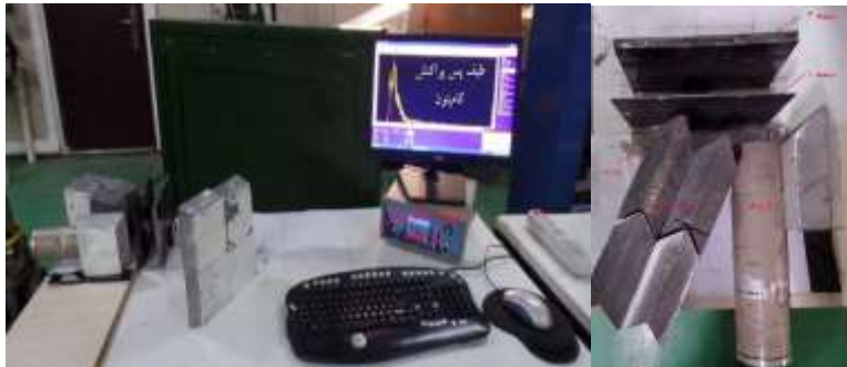
شکل (۲). چیدمان تجهیزات و صفحه‌های تحت آزمون پس پراکنش حاصل از پدیده کامپتون
