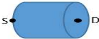
شکل ۲: هندسه شیب ساز شده چشمه (S)، آشکارساز (D) و نمونه استوانه‌ای شکل به شعاع ۳m در تعیین ضریب انباشت شار.
