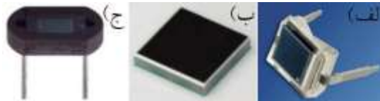
شکل ۱. دیودهای نوری استفاده شده در آزمایش (الف) BPW34B، (ب) S10357 و (ج) BS500B
