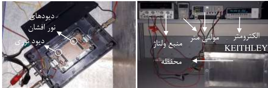
شکل ۳. چیدمان آزمایش و محفظه فلزی ساخته شده برای اندازه‌گیری جریان تاریکی و جریان حاصل از تابش دیودهای LED
