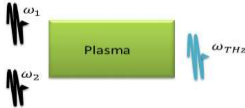
شکل ۱: طرح‌واره تولید امواج تراهرتز ناشی از برهمکنش دو باریکه لیزری با فرکانس‌های (\omega_1, \omega_2)
