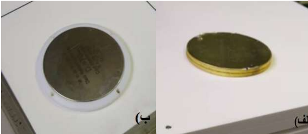
شکل (۱). الف) دیسک ساخته شده از جنس سرب و آلومینیوم ب) دیسک خود دستگاه LIAC از جنس استیل و پلاستیک
